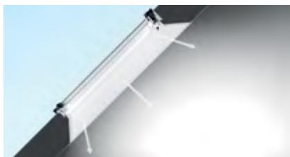
Üst ve alt pervaz parçalarını geniş açı ile birleştirmek içeri daha fazla gün ışığı taşınmmasını sağlar.
