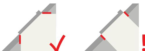
İkinci kural; çatı penceresinin altına bir radyatör yerleştirmektir. Bu, sıcak havanın pencereye akmasına ve pencere bölmesi boyunca dolaşmasına izin verir ve yoğunlaşma riskini ortadan kaldırır.
